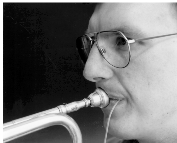
Abb. 5: Versuchsanordnung; Kabel von der Messplatte durch den Mundwinkel zum Verstärker
